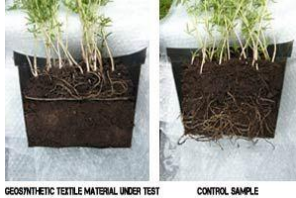
Şekil 8 - Bitki kökü geçirgenliği ile ilgili deney tüpleri
